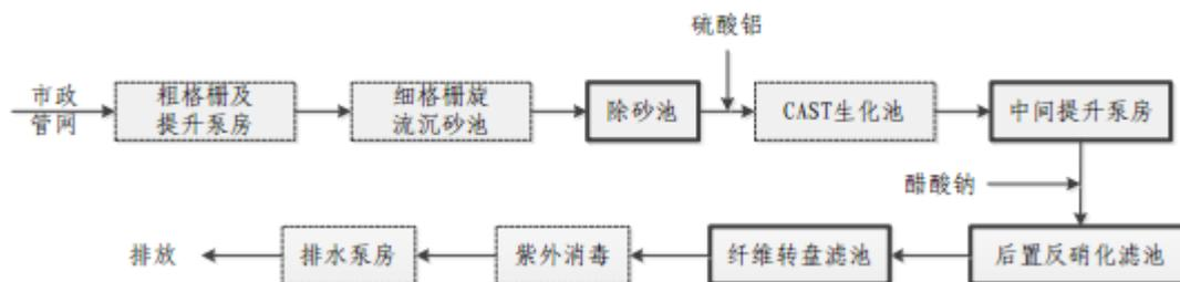
图 2-1 污水厂工艺流程图
